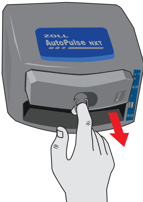
Figure 6.4. Retrait de la batterie du chargeur de batterie
